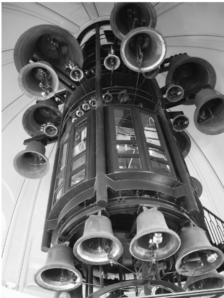
Ein Blick in das Glockeninnere. Die beiden kleineren Glocken in Bildmitte sind mit Sensitiv-Hammerwerken ausgerüstet.
