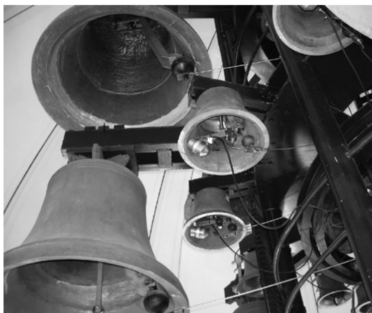
Ein Blick in das Glockeninnere. Die beiden kleineren Glocken in Bildmitte sind mit Sensitiv-Hammerwerken ausgerüstet.
