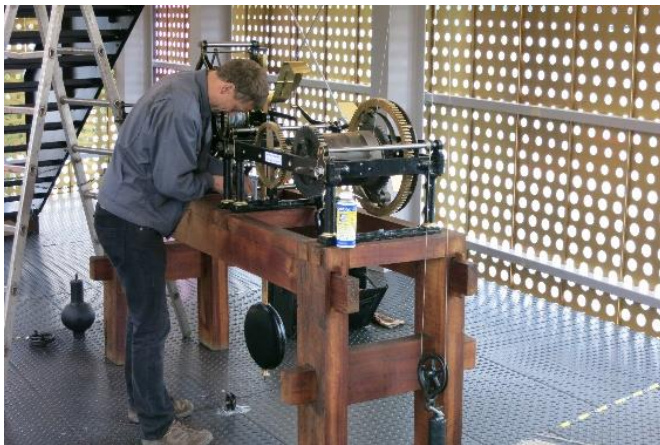
Sebastian Otto bei Justagearbeiten am Uhrwerk
